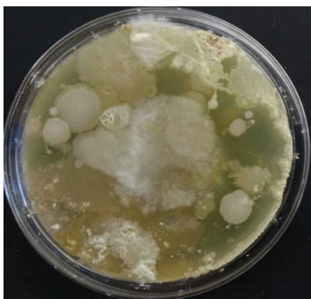
Fig.122 – Ponto de coleta 9: Imagem fotográfica da placa RODAC PLATE® com incubação a 35 °C por 48 horas evidenciando colônias de microrganismos
