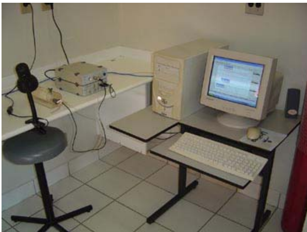
Figura 3: Visão geral do sistema não invasivo “tail-cuff” da Power Lab NIBP System, para aferição da pressão arterial.
