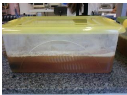
Figura 7. Circuito respiratório depois de 24 horas de imersão no caldo BH.
