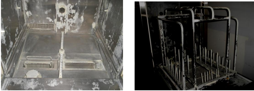
Figuras 11 e 12 Formação de incrustações na lavadora a termodessecadora
