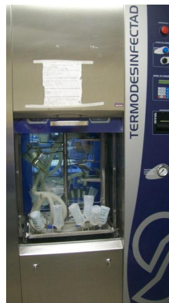
Figura 4. Lavador a termodesinfetador a Sercon, usada no Hospital B
