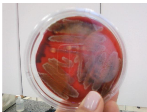
Figura 10. Placa de ágar sangue apresentando o crescimento de Enterococcus sp, após inoculação de amostra de caldo BH usado para imersão da hélice da termodesinfectora.
