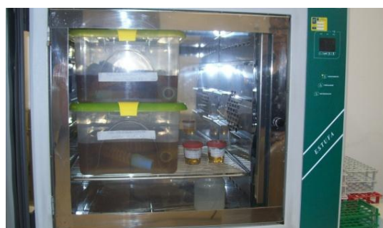
Figura 8. Amostras dos circuitos respiratórios na estufa a 37°C
