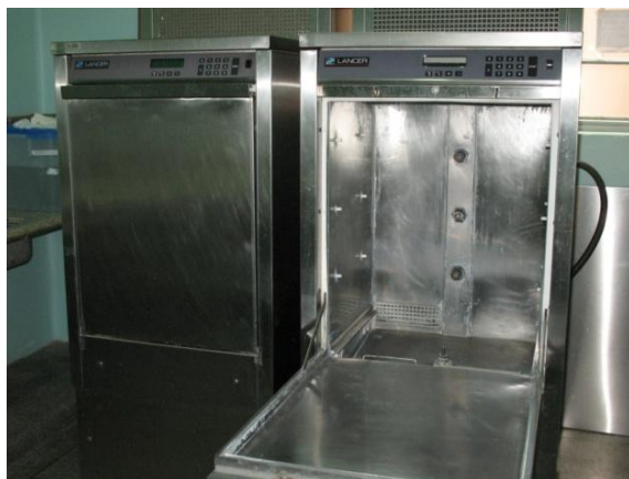
Figura 3. Lavador a termodesinfetador a Lancer, usada no Hospital A
