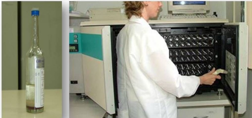
Figura 2: Frasco de hemocultura com resina para adsorção de antibióticos e aparelho Bactec ® , utilizados para realização da hemocultura automatizada.
